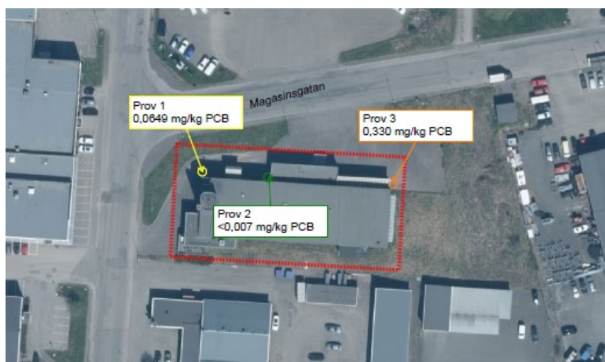
Figur 3. Uttag av jordprover i samband med PCB-sanering på fastigheten Eldaren 1 vintern 2022 (bildkälla: Relement, 2022).
